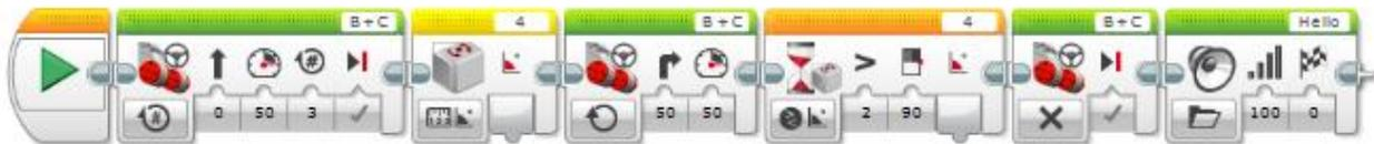
Auch dieses Programm wird noch immer fehlerhaft ausgeführt. Der Sensor braucht eine minimale Zeit, in der der Roboter in Ruhe ist, um exakte Messwerte liefern zu können. → Deshalb empfiehlt es sich, vor und nach dem Zurücksetzen des Kreiselsensors eine kurze Pause einzuprogrammieren. (Erfolgt die Drehung nicht unmittelbar nach dem Zurücksetzen des Sensors, so sollte auch vor Beginn der Drehung eine minimale Pause programmiert werden.)
