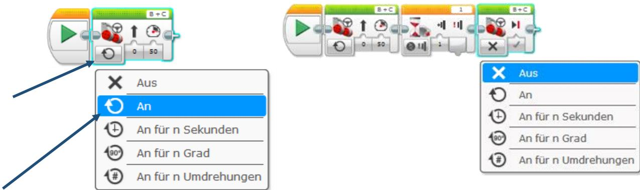
Der Roboter fährt solange geradeaus vorwärts, bis er mit dem Tastsensor auf ein Hindernis stößt, dann bleibt er stehen, gibt 2 Sekunden lang einen Warnton von sich, fährt 3 Umdrehungen rückwärts und dreht sich dann um, dass er in Richtung des Ausgangspunktes schaut.
